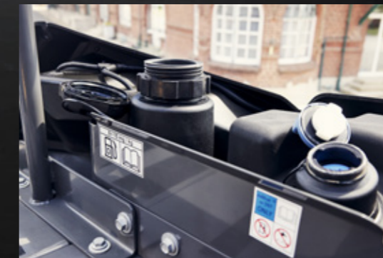
Repostaje sencillo: las bocas de llenado de los depósitos de diésel y AdBlue están una al lado de la otra para un acceso práctico
