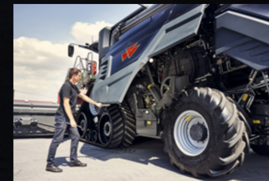
Los paneles de una pieza con luces proporcionan un acceso rápido y cómodo para la inspección
