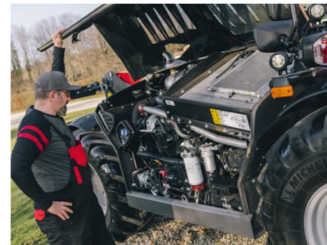
▲ Con un capó reforzado y una apertura más grande, los modelos MF TH se benefician de un nuevo sistema de apertura del capó que facilita el acceso para mantenimiento.
