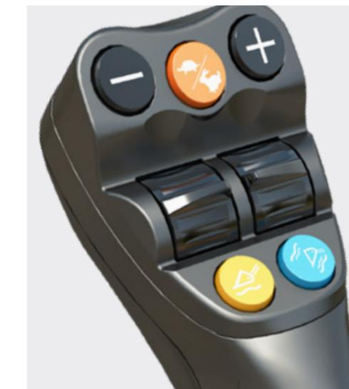
**EL MOVIMIENTO DE CAZO** es una nueva característica opcional que se incorpora con la posición de flotación de brazo en el nuevo joystick. Ahora el operador puede vaciar fácilmente el apero de materiales pegajosos presionando el interruptor azul y moviendo el joystick al mismo tiempo.
