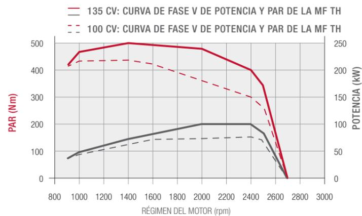
Podá contar con todo el par que necesite en aplicaciones que exijan más tracción y fuerza, lo que le permitirá trabajar a revoluciones más bajas del motor y así ahorrar combustible. La potencia se ha ampliado hasta 135 CV a 2.000 rpm.
