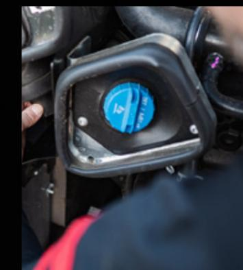
▶ Depósitos de gasoil y AdBlue® de fácil repostaje desde el suelo.
