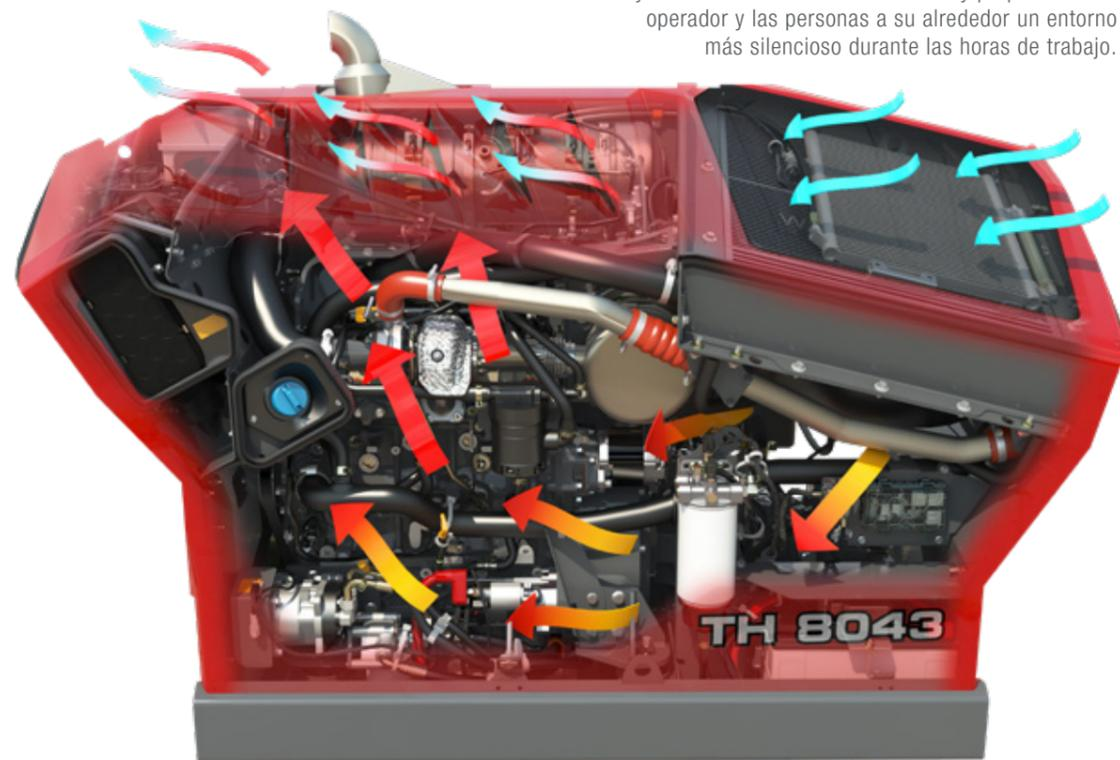
▲ La nueva posición del motor y el diseño tipo jaula han permitido rebajar la altura del motor para mejorar la visibilidad del lado derecho. El paquete de refrigeración horizontal incorpora capacidades de refrigeración óptimas.
