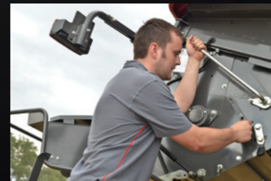
Fácil cambio de la posición de picado a hilerado para empacado
